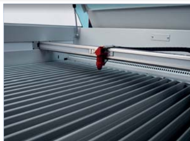
Стол для резки с алюминиевыми пластинами, которые позволяют избежать отражения луча
