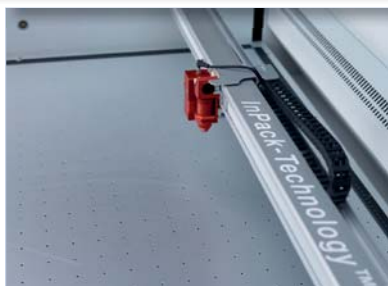
Вакуумный стол для обработки тонких и легких материалов
